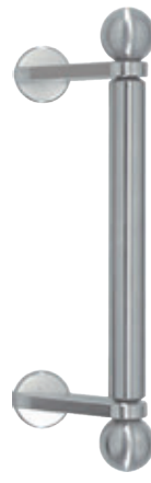
V 764-13 Lengte: 295 mm Ø: 24 mm Hartafstand: 210 mm
